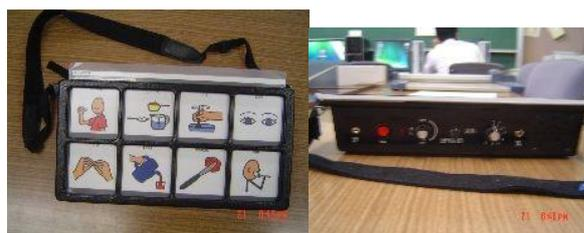
8個のボタンにそれぞれ4.5秒ずつの音声を録音し、再生させるシンプルな代替コミュニケーション装置です。背面のレベル変更のダイヤルを切り替えれば、8個の音声を6場面分、全部で48個の音声を録音し、再生することができます。
