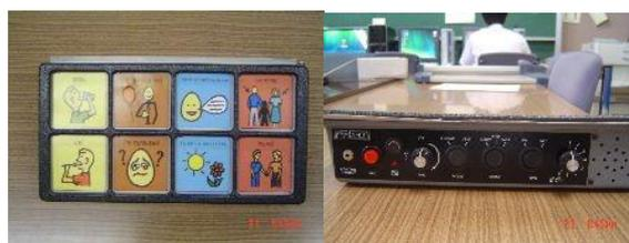
8個のボタンにそれぞれ4.5秒ずつの音声を録音し、再生させることができます。背面のレベル変更のダイヤルを切り替えることで、1画面8個の音声、全部で64個の音声を録音し、再生することができます。軽く、持ち運びに便利です。
