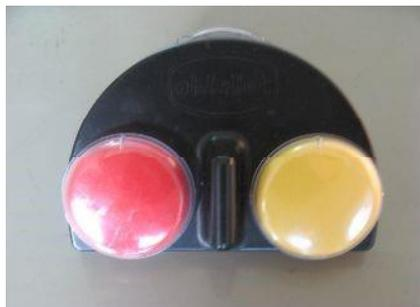
左右の2つのスイッチに各8.5秒、合計17秒のメッセージを録音・再生することができます。音量調節したり、外部スイッチをつないで再生させたりできます。接続した機器類を音声再生の間、作動させることもできます。
