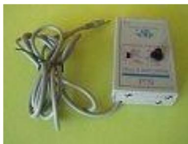
設定された時間（1秒～60分まで）スイッチ入力を持続させるタイマー機能と、スイッチを押すと再度押すまでスイッチ入力が続くラッチ機能が選択できます。
