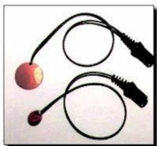
玩具等の電池ボックスの電池と電池接点の間に挟み込んで、外部スイッチで操作できるようにします。
